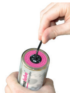
Активируйте лубрикатор, установив период подачи на рассчитанное время шестигранным ключом
