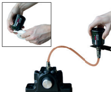
Используя уплотнительную ленту, установите IMPULSE в точку смазки i логотип IMPULSE должен быть спереди
