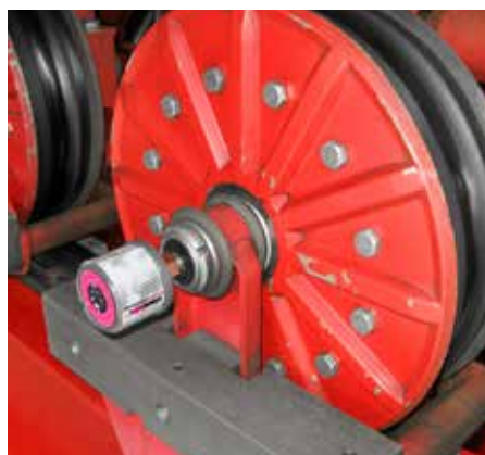
Направляющие ролики подъемника канатной дороги снабжаются необходимой смазкой.
